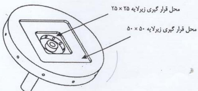
سپس دستگاه را روشن نموده و تنظیمات لایه نشانی را انجام و دستگاه را استارت نمایید. پس از رسیدن به سرعت مورد نظر ، محلول مورد نظر را از طریق سوراخ تعییه شده در درب دستگاه ، بر روی زیرلایه تزریق نمایید.
